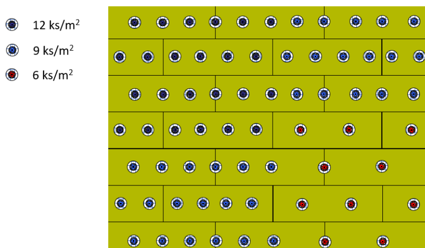
Obr. 11d Příklady rozmístění kotvicích hmoždinek příčné vlákno 333 x 1000; TR80 schéma kotvení
