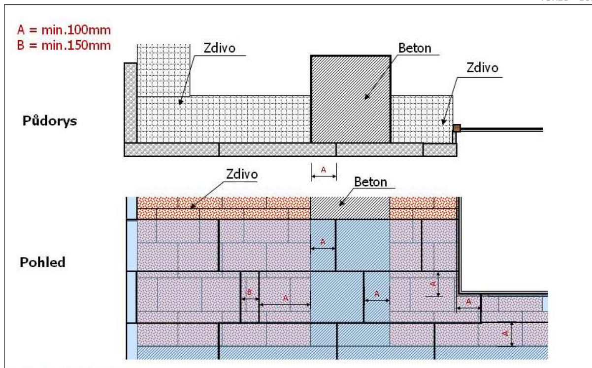
Obr. 5 - Kladení fasádních tepelně izolačních desek
