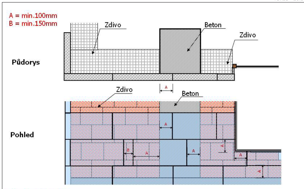
Obr. 5 – Kladení fasádních tepelně izolačních desek
