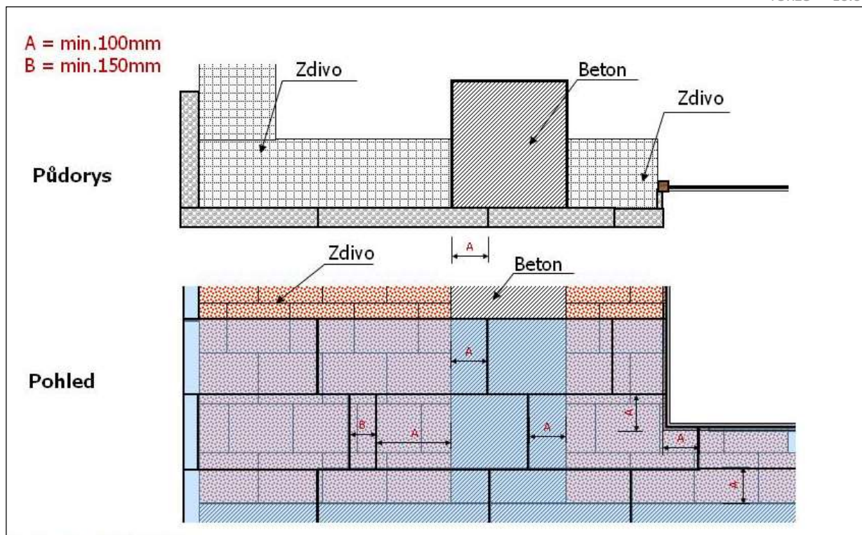
Obr. 5 - Kladení fasádních tepelně izolačních desek
